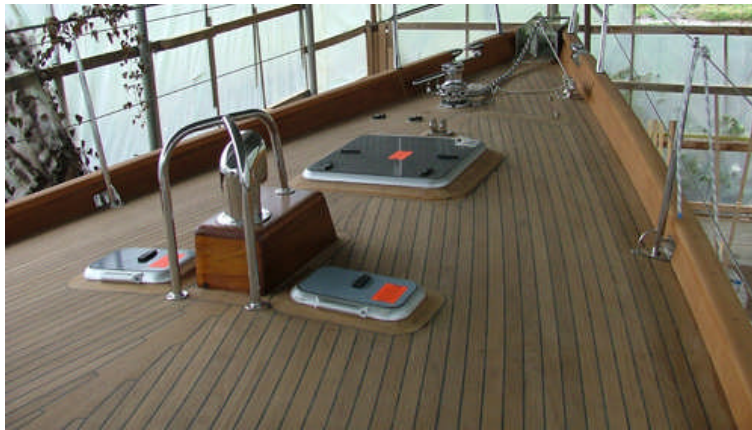
Resim 1.3: Bordadan merkeze gövde formu kaplama
