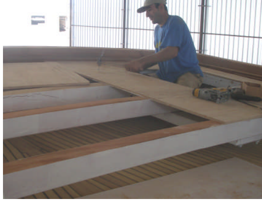
Resim 2.4: Güverte kemeresi üzerine su kontrplağının çakılması
