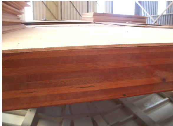
Resim 2.3: Güverte kemeresi üzerine su kontrplağının yerleştirilmesi
