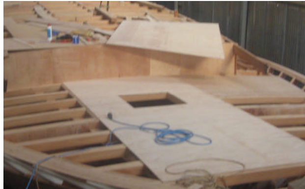
Resim 2.6: Su kontrplağı yerleştirilirken ambar ağızlarındaki bitişleri
