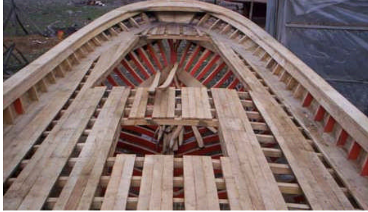
Resim 2.2: Güverte kaplamalarının döşeneceği yerlere tespit edilmesi.
